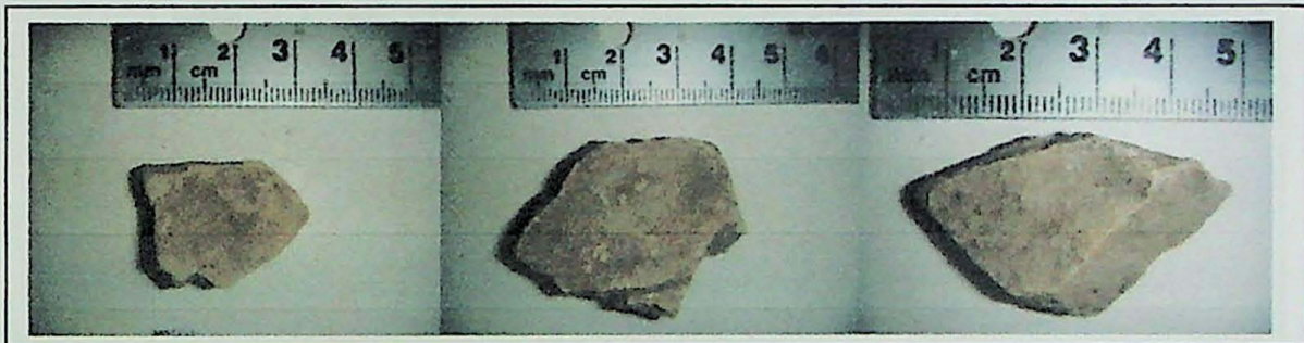
Fig.8.11. Fragmentos das amostras M14b, M15 e M19 respectivamente, apresentando faces definidas, e extremidades pontiagudas.
