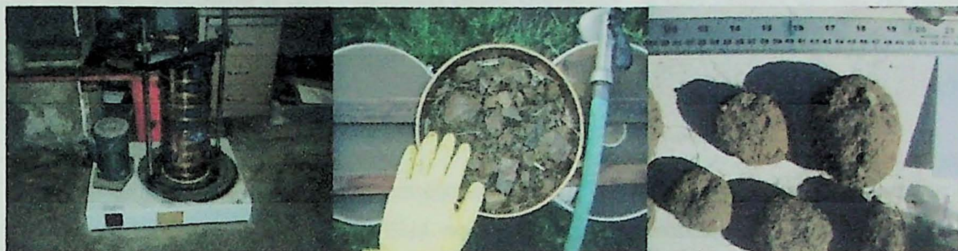
Fig.6.8, 6.9 e 6.10. Da esquerda para direita: fragmentos agregados a solo antes da lavagem; lavagem dos fragmentos e peneiramento.
