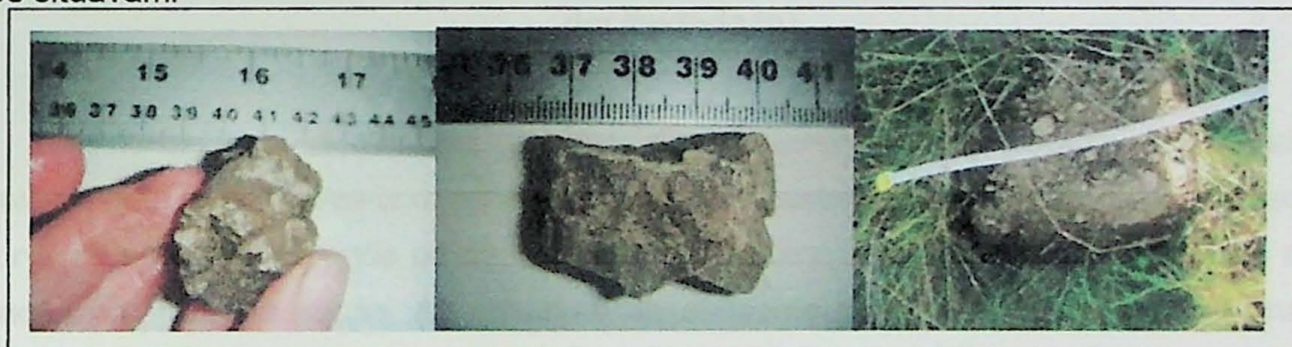
Fig.8.30. Da esquerda para direita: Fragmento da amostra M29 com inclusão silicosa; fragmento de formato bastante geométrico da amostra M28 e formato típico da forma do rejeito encontrado nas amostras pertencente à M32.
