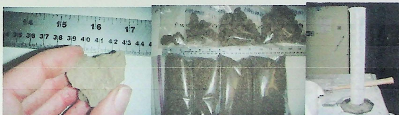
Fig.6.11, 6.12 e 6.13. Da esquerda para a direita: escolha do fragmento para as medidas subseqüentes, amostra separada nas classes granulométricas e tubo volumetricamente demarcado utilizado para a medida do volume.
