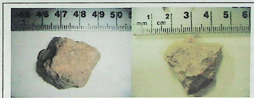
Fig.8.12. Fragmentos das amostras M16 e M17 respectivamente, com rugosidade nas faces e extremidades cominuidas.
