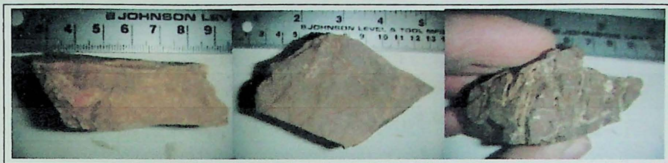
Fig.8.42. Fragmentos do chert amostrado, com formas geométricas e inclusões silicosas
